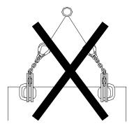
• Für das Heben von Blechen in Horizontallage: eine Traverse ist einzusetzen und die Traglast wird gemindert (Siehe Skizze).
